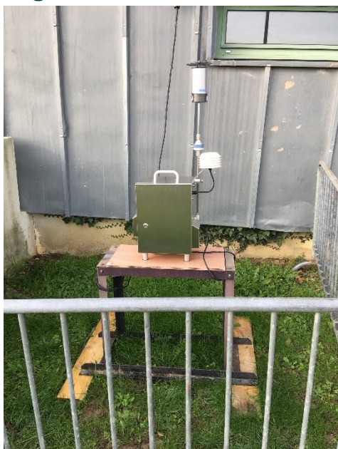
Vue du préleveur d'acide chlorhydrique gazeux
