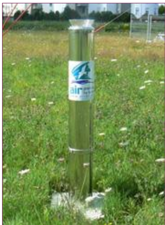
Collecteur installé sur site
