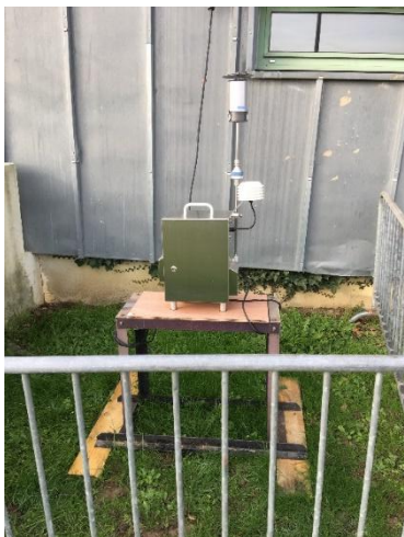
Vue d'un système de prélèvement par filtre
