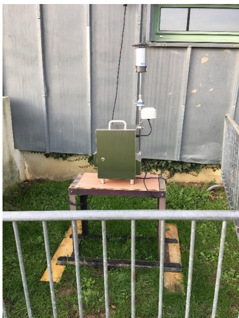
Vue du préleveur d'acide chlorhydrique gazeux
