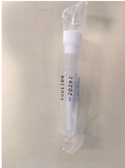
Figure 10 : boîte d'exposition des tubes, placée dans un corps diffusif bleu Radiello à l'aide d'un support triangulaire (à gauche). Tubes Radiello code 166 à usage unique (à droite)
