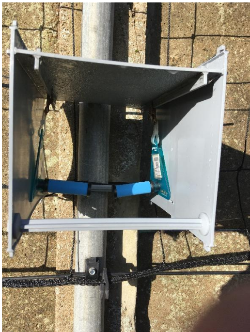
Figure 10 : boîte d'exposition des tubes, placée dans un corps diffusif bleu Radiello à l'aide d'un support triangulaire (à gauche). Tubes Radiello code 166 à usage unique (à droite)
