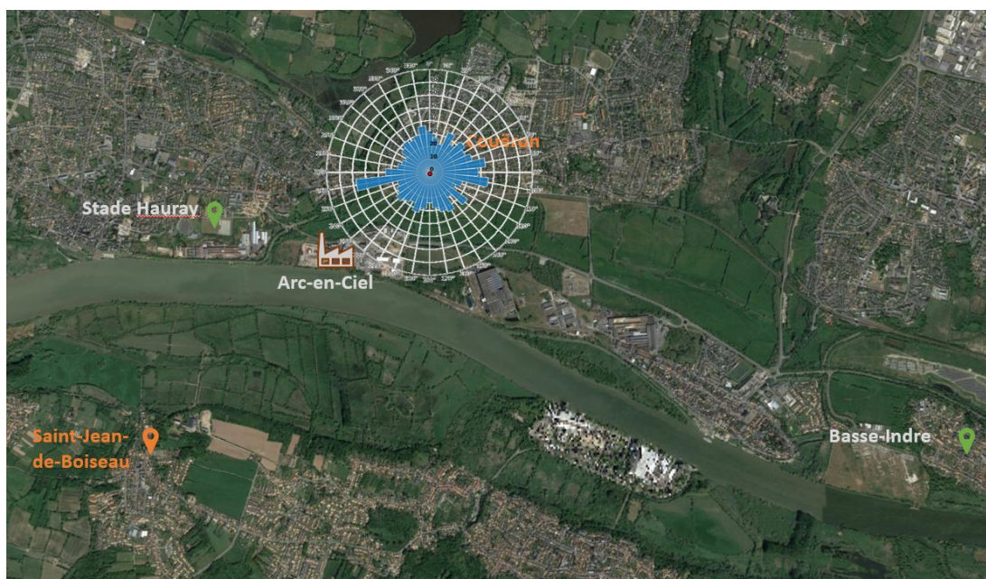
Figure 21 : rose de pollution des concentrations de pointe (P98) en PM10 mesurées sur le site de la Gendarmerie à Couëron
